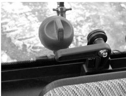
**Dessous de toit de cabine :** Le dessous de toit est garni d'un rembourrage en matériau isolant pour limiter à la fois les rayonnements thermiques à l'intérieur de la cabine et l'élévation de la température dans les régions ensoleillées. Le dessous de toit présente également une trappe.
