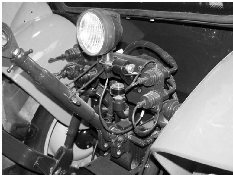
Nettoyer parfaitement les protections en caoutchouc et les placer dans les coupleurs.
