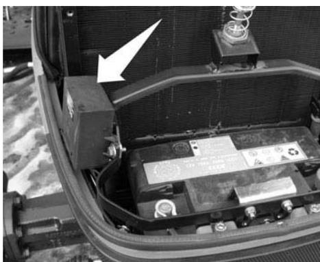
Unité de contrôle de la température du moteur
