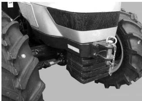
Il est possible d'ajouter 4 masses à panier (25 kg chacune) aux masses à plaques en les montant à l'avant du tracteur au moyen d'un support prévu à cet effet
